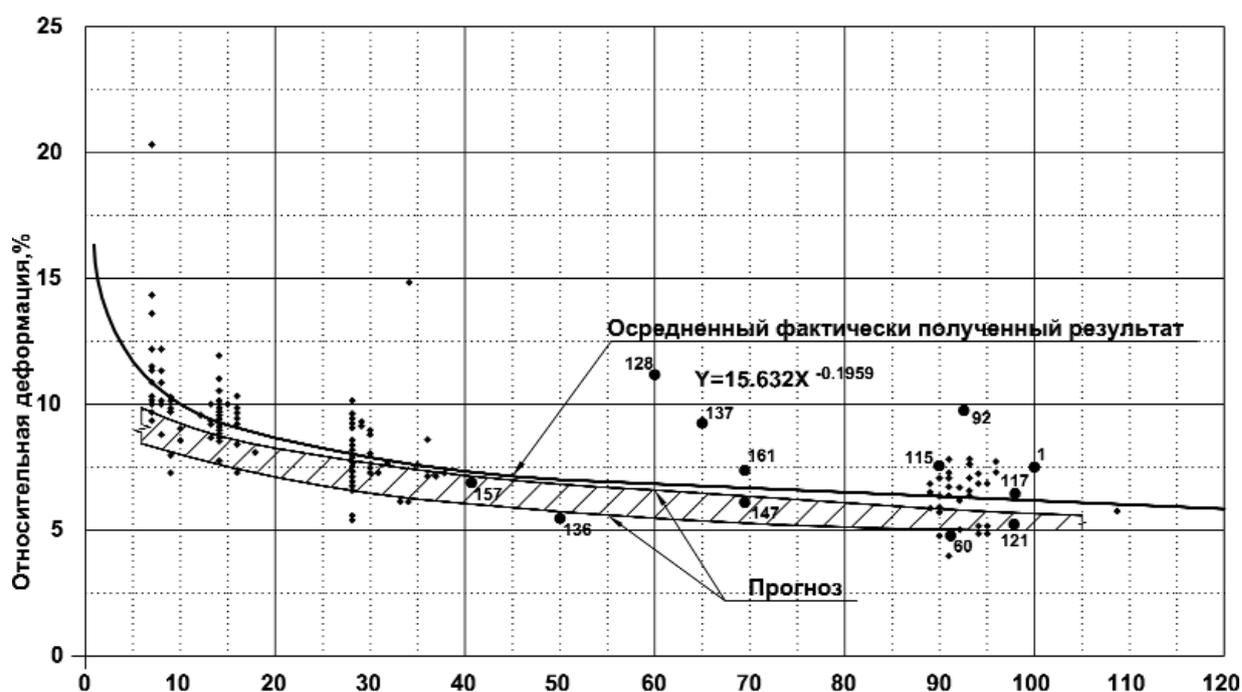
Рис. 4. Изменение во времени относительной деформации бетона МС-3, фактически полученной по пробам раствора, взятым при бетонировании  $\blacklozenge$  и монолитам, взятым из тела завесы  $\bullet$ , и по прогнозу  $\text{шaded}$
