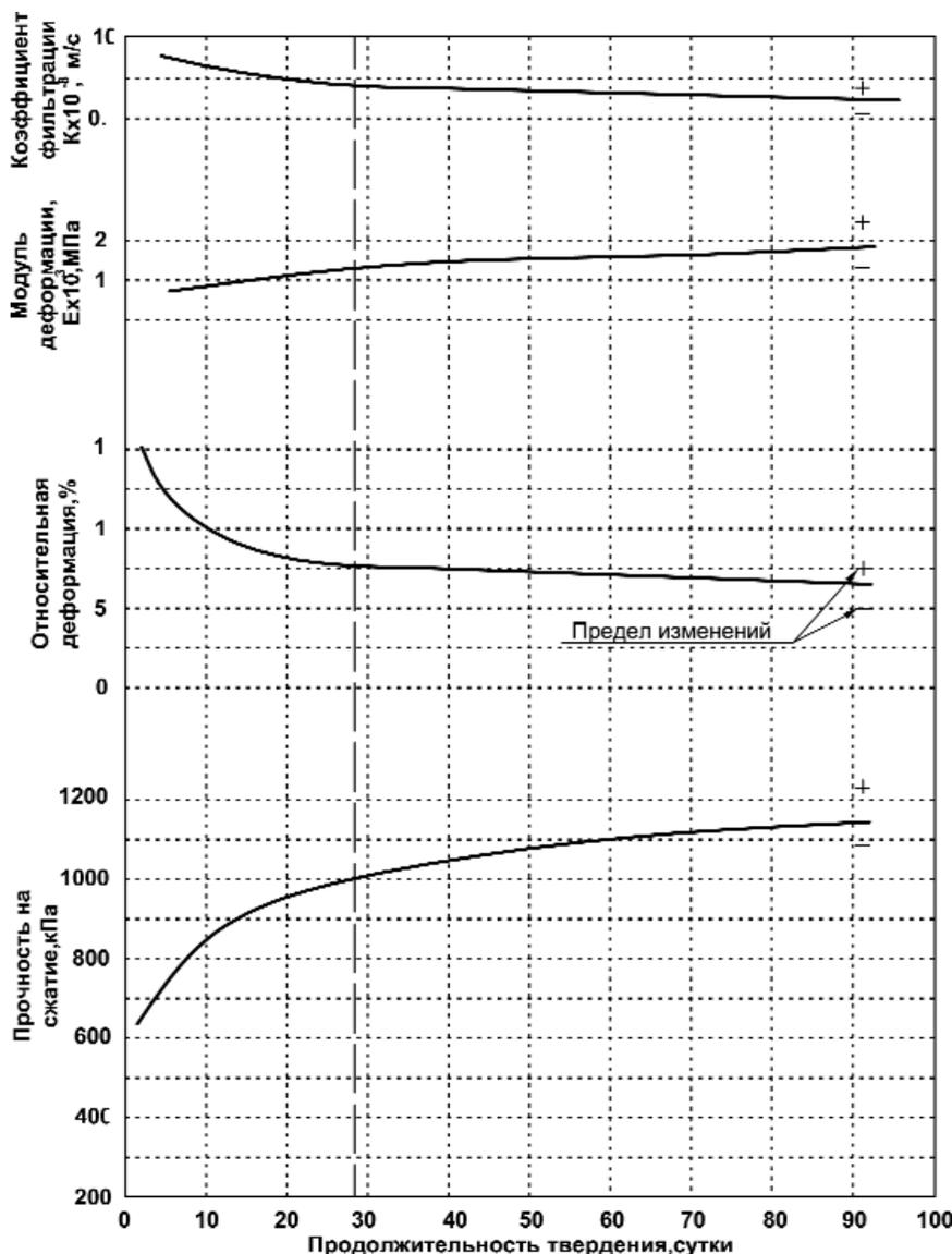
Рис. 3. Промежуточные результаты лабораторных испытаний пластичного бетона МС-3, уложенного в первые 24 панели при  $\sigma_3=200$  кПа,  $V_{it}=0,05$  мм/мин
